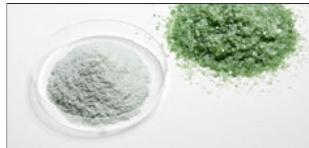
Glas vor und nach der Mahlung mit der Planeten-Mikromühle PULVERISETTE 7 *premium line*
