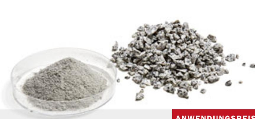
Optimale Aufbereitung einer Granitprobe mit der Planeten-Mikromühle PULVERISETTE 7 *premium line*
