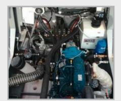
Der mechanische 3-Zylinder-Dieselmotor von Kubota erfüllt die Abgasnorm "Stage V" und ist äußerst effizient und wartungsfreundlich. Dies führt zu beeindruckend niedrigen Kosten für Betrieb und Wartung.
