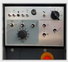
Die Bedienung der Maschine erfolgt direkt über das einfache und intuitive Bedienfeld oder über eine Funkfernsteuerung.
