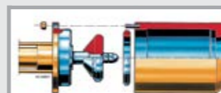
Einfacher Ventilwechsel ohne Rohrleitungs-demontage
