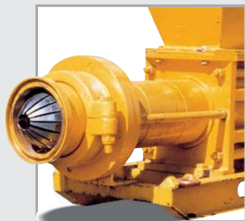
EKO 1060 mit Lamellen-Rückschlagventil
